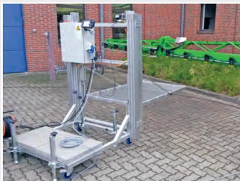
Dieser Prüfstand testet die Parallelführungsfunktion eines Spritzgestänges
