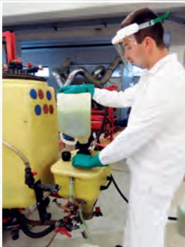
Closed-Transfer Systeme helfen die Anwenderkontamination zu senken
