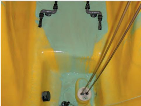
Blick in den Tank bei der Rührwerksprüfung mit Kupferlösung
