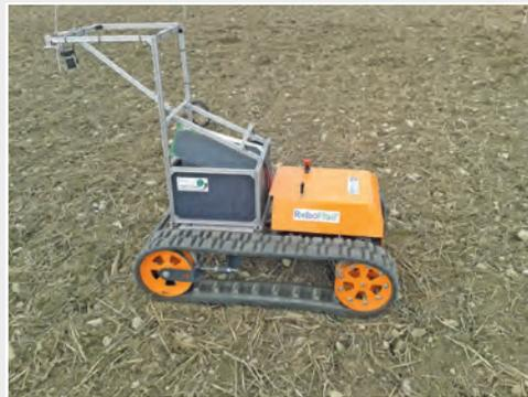
Prototyp eines Schneckenroboters zum Auffinden und Beseitigen von Schnecken
