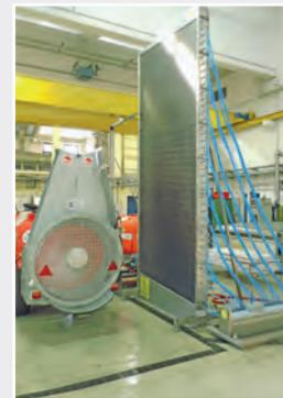
Vertikalverteilungsprüfstand für Pflanzenschutzgeräte mit Luftunterstützung in Raumkulturen
