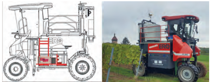
Abb. 3: Phenoliner: ein Prototyp zur Methodenentwicklung für Phänotypisierung im Weinberg und Präzisionsweinbau.
