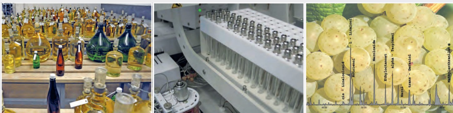
Abb. 6: Qualitätskontrolle an Most und Wein: L. Wein der Mikrovinifikation (Kleinmaßstab 1 – 100 Liter), Mi. Proben in der Gaschromatographie, r. Aromastoffprofil im Traubenmost zur Früherkennung des unerwünschten Methylanthranilats (* = Walderdbeeraroma) im Most, das zu einem Ausschluss des Rebstockes führt. Fig. 6: Quality control in must and wine: L. wine in microvinification (scale 1 – 100 Liter), mid. gaschromatographic samples, R. aroma profile of grape must showing the undesired methylanthranilate (* = wild strawberry flavor) resulting in the early removal of the plant from further evaluation.
